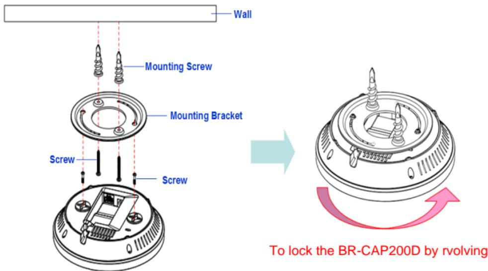
3) 安装BR-CAP200D安装支架上的旋转装置，顺时针90度旋转，以确保它牢固。
